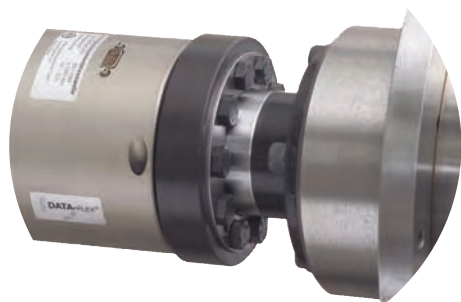
Połączenie zaciskowe piasty z momentomierzem DATAFLEX® poprzez pierścień KTR 620
